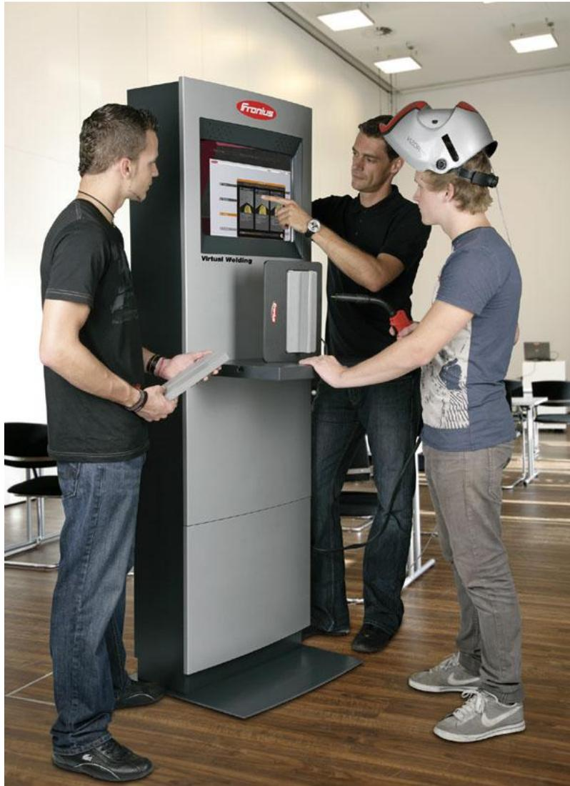
*Bild 1: Beim virtuellen Schweißen erwirbt der Auszubildende am Terminal spielend und gefahrlos die erforderliche Handfertigkeit, bevor er erstmals einen Brenner mit 2000°C heißem Lichtbogen führt. Die optische Sensorik steckt im Helm, die kinetische (magnetische) unter dem Probewerkstück.*
