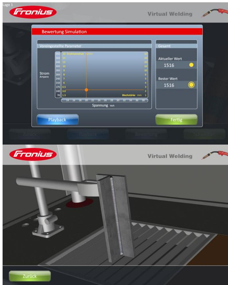
*Bild 3: Ein magnetisches Trackingsystem überträgt die Handbewegungen, die der Benutzer mit dem Brennermodell ausführt, in die Virtualität. Der individuelle Ausbildungsfortschritt lässt sich speichern und in seinem Verlauf motivationsfördernd demonstrieren.*
