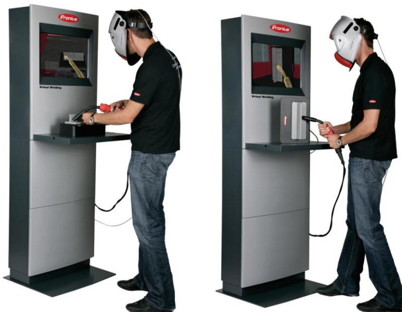
Bild 6: Das Fügen unterschiedlicher Verbindungsarten wie die V-Naht in der Position PF vertical up oder die Kehlnaht in der horizontalen (PB-) Brennerposition eignet sich der Auszubildende in praktischen Übungen mit Virtual Welding an.
