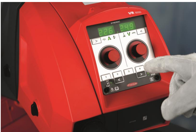
Bild 7: Über das Bedienpanel an der abnehmbaren Drahtfördereinheit wählt der Nutzer die benötigten Funktionen intuitiv geführt per Tastendruck an.
