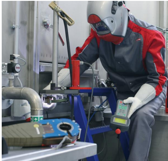
Bild 1. Kreisförmige Verbindungen in höchster Qualität und Reproduzierbarkeit erzeugt die neue Orbital-Schweißsystemsteuerung von Fronius äußerst wirtschaftlich.
