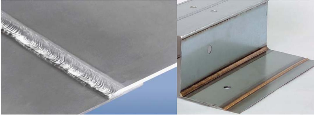
1: Eine innige Verbingung von Aluminium mit Stahl erzeugt der CMT-Prozess per Lichtbogenfügen.
