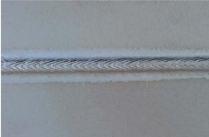
Bild 6: Kehlnaht an einem 1,0mm AlMg3-Blech, CMT-geschweißt mit 2,0 m/min Schweißgeschwindigkeit.
