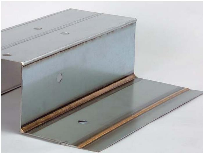
Bild 4: CMT-gelötete Verbindung eines feuer- mit einem elektrolytisch verzinkten Blech; Blechdicke 1,0 mm, Zusatzwerkstoff CuSi3.
