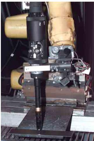
*Bild 17 : Robacta Drive Brenner zur spritzerfreien Zündung des MIG-Lichtbogens*
