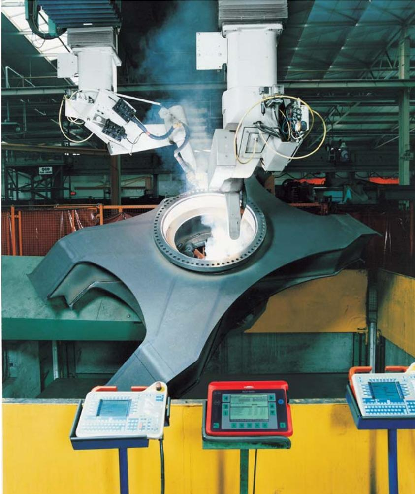
7: Besonders zum Fügen von großen, mit Handlingsystemen bewegbaren Werkstücken, eignet sich das Flachdrahtschweißen.
