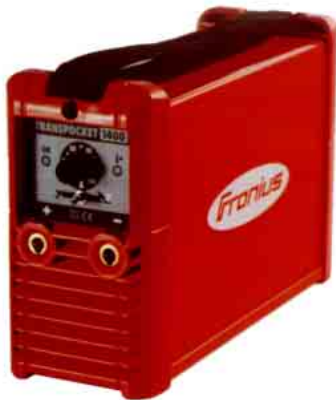
Bild 4: 140 Ampere Inverter für das E-Handschweißen mit 4,2 kg und 35 % ED bei 40°C Umgebungstemperatur
