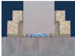
Der Bolzen wird unter Stromfluss abgehoben. Dadurch entsteht ein Lichtbogen.
