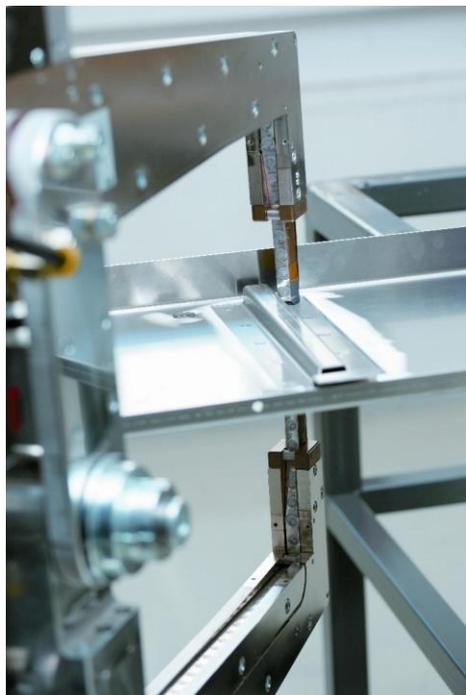
1: Punktschweißen unterschiedlicher Werkstoffe mit umlaufenden Prozessbändern erzeugt qualitativ neue Ergebnisse bis zur Dokumentation jedes Schweißpunktes.
