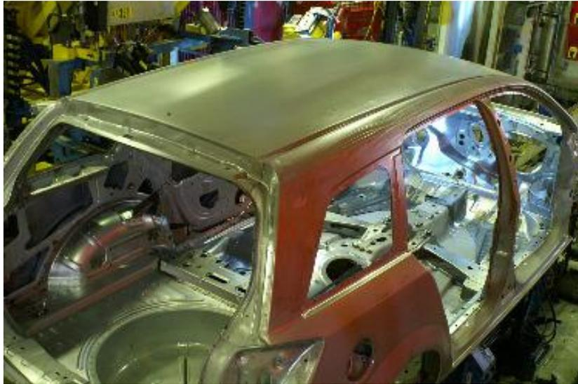
2: Schweißen, Löten und Schweißlöten mit dem „kalten“ CMT-Prozess spart Zeit, Kosten und ist gut in automatisierte Taktprozesse integrierbar.
