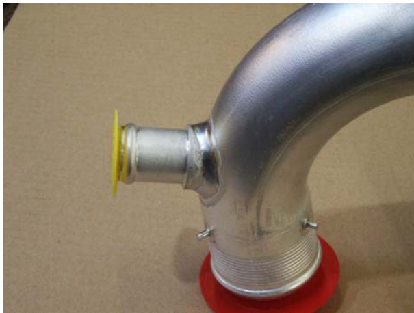
3: Das Aluminium-Funktionsrohr fertigt der Fahrzeugbau-Zulieferer ELB-Form mit spritzerfrei CMT-geschweißten Anschlüssen.
