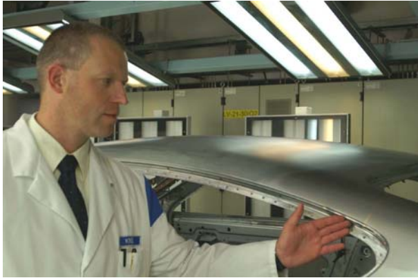
2. Für Andreas Krüger, Leiter Karosseriebau D-Klasse bei VW Sachsen, besteht der Hauptnutzen der CMT-Technologie von Fronius aus den Vorteilen des 20 bis 30 Prozent geringeren Wärmeeintrages. Er verweist auf die einwandfreie Naht an der C-Säule des Bentley Continental GT.
