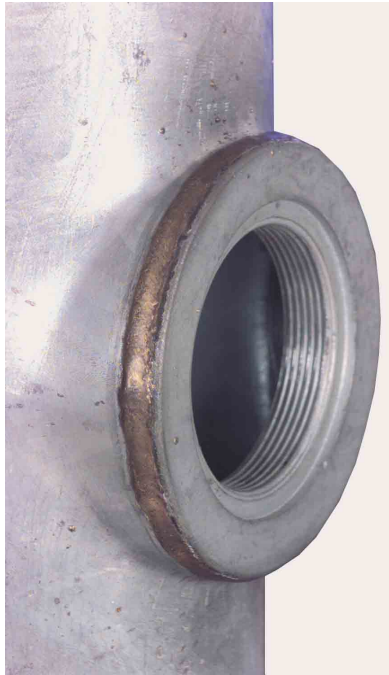
Pic 2: Spritzerarmer Lötprozess
